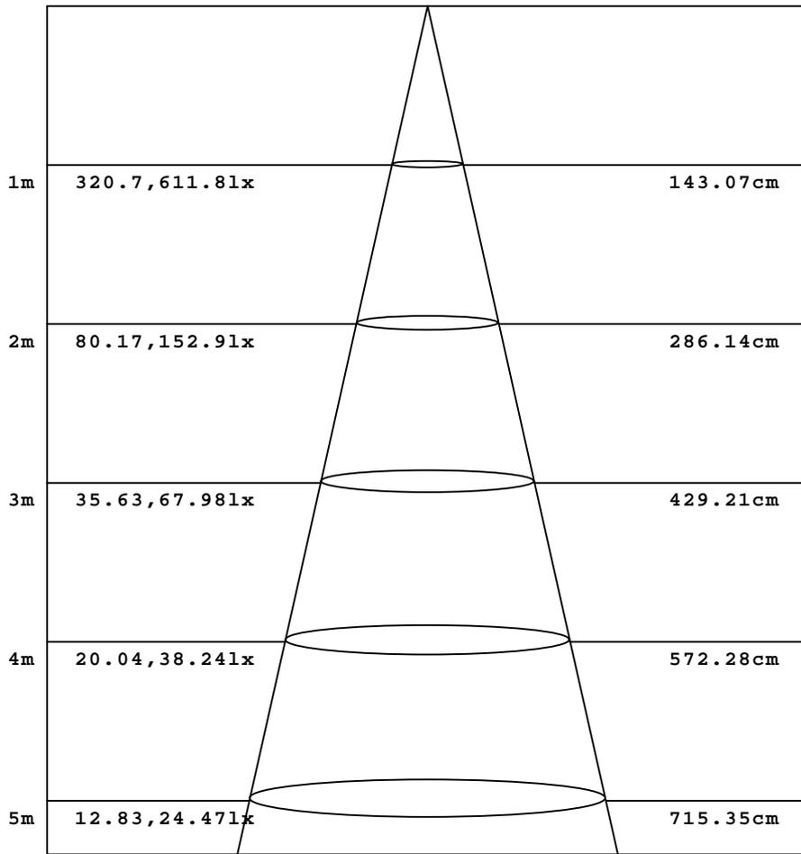
高度 Eavg, Emax 光束角:71.16度 直径
